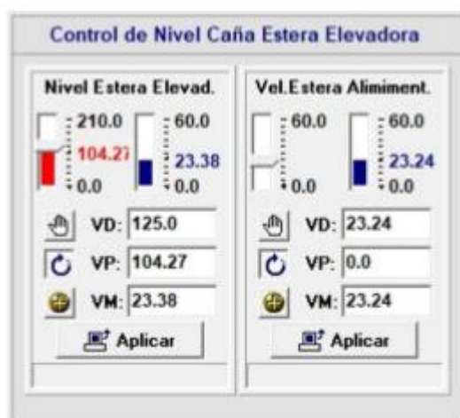
Figura 4. Ventana para ajuste de controladores, lazo de nivel de caña
